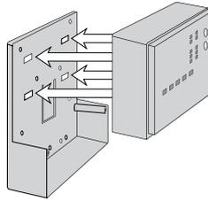
10. Placer la nouvelle tête de commande sur la base, en alignant ses quatre languettes avec les quatre ouvertures sur la base, puis la faire glisser vers le bas jusqu'à ce qu'elle s'enclenche.
