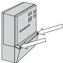
4. À l'aide d'un tournevis, desserrer les deux vis à l'avant du couvercle de câblage.
