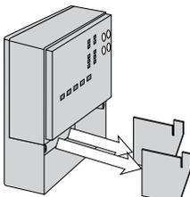
6. Retirer les deux séparateurs de sécurité du boîtier de câblage en les tirant directement hors de leurs rainures.
