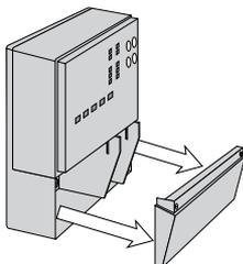
5. Retirer complètement le couvercle du boîtier du câblage.
